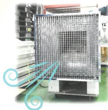
耐久試験の様子 写真は SUS 製レジです
